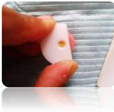
Fig.36 Espécimen de Cemento Dual.
