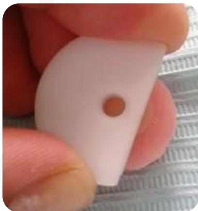
Fig.31 Aditamento de teflón sobre la muestra
