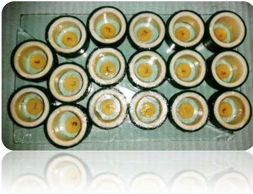
Fig.26 Muestras de adoro dentro de los anillos de plástico.
