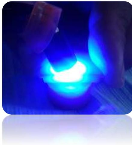
Fig.33 fotopolimerizado del espécimen de resina.
