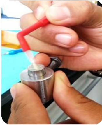
Fig.11 Aplicación de liner 300 en el conformador de muestras.
