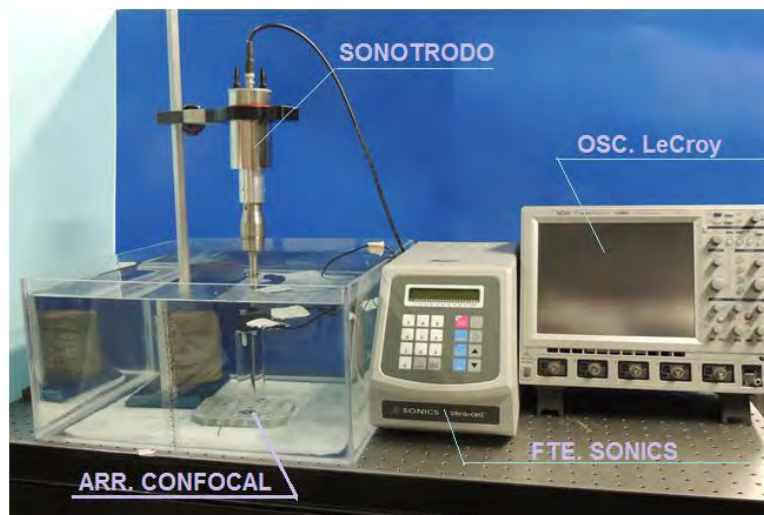
Fig 24. Arreglo experimental empleando el Sonotrodo como generador de burbujas.
