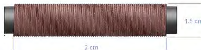
Fig 22. Dimensiones de la Bobina empleada para el acoplamiento de impedancias
