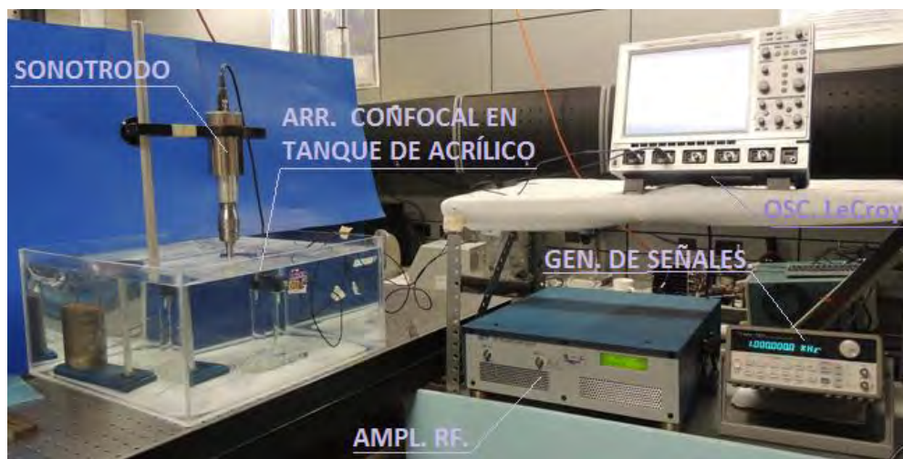
Fig 26. Arreglo experimental empleando el Sonotrodo como emisor de frecuencia variable.
