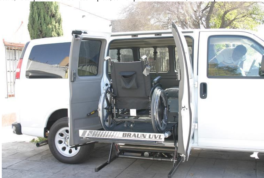
Figura III.4: Muestra, la adaptación en una unidad Express, con rampa de base deslizante, auxiliada por un brazo mecánico.
