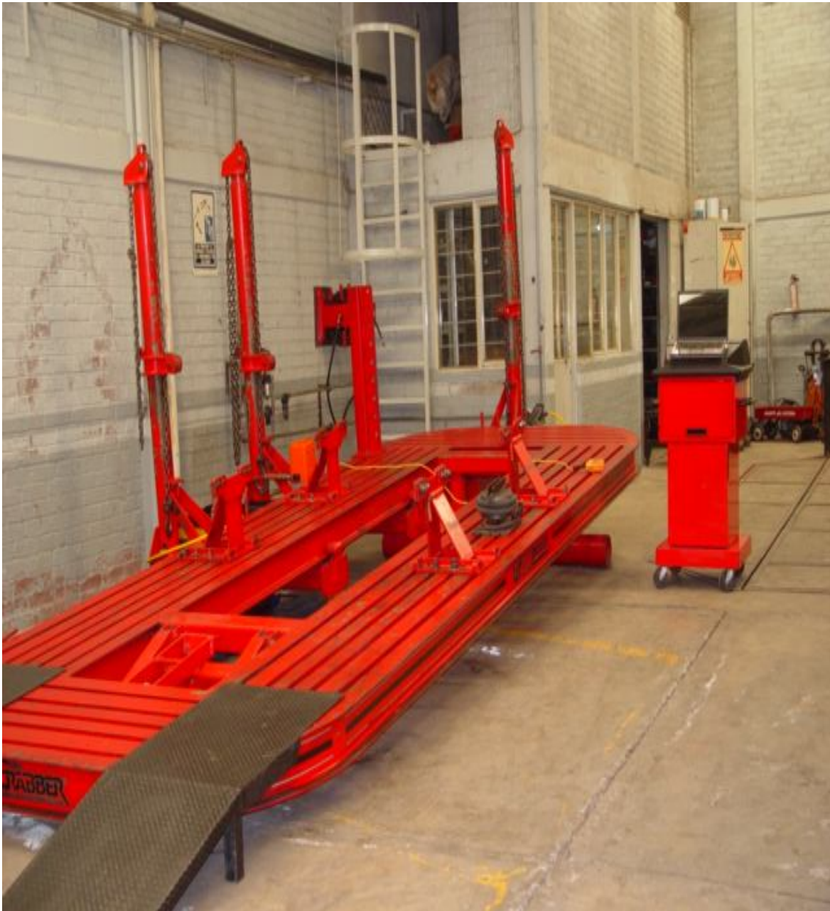
Figura IV.4. Muestra la plataforma conocida como banco de enderezado así como el quipo de medición.
