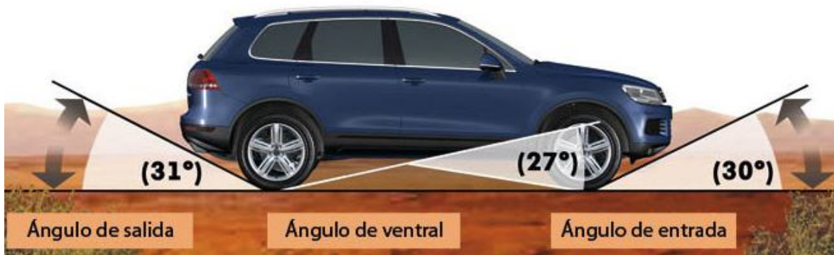
Figura V.2. Muestra los ángulos requeridos de ataque y salida en vehículos.
