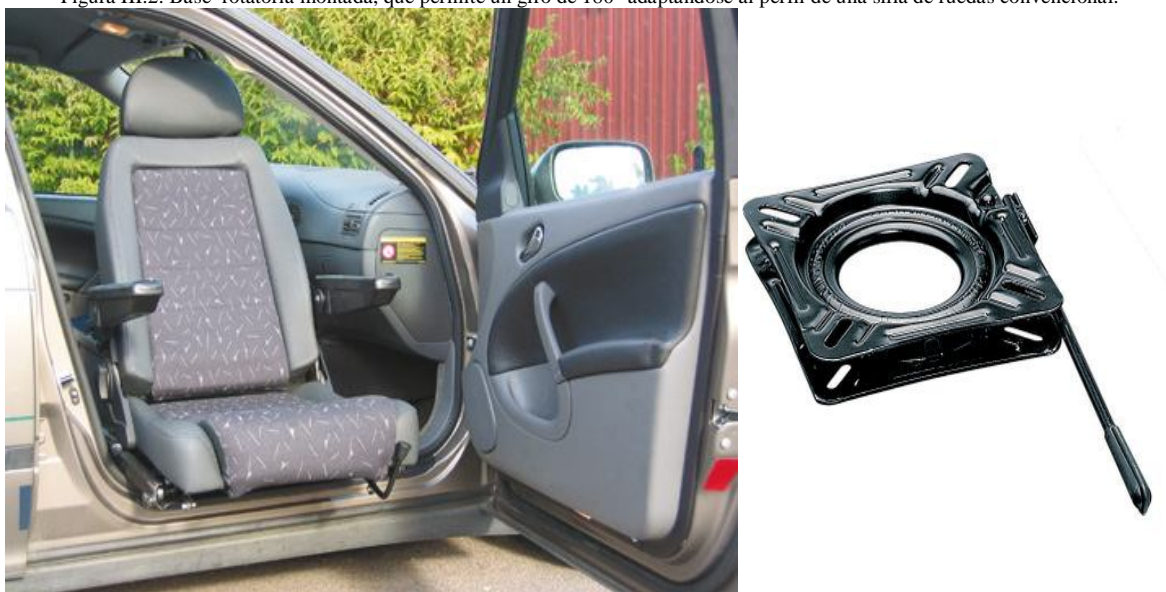
Figura III.2: Base rotatoria montada, que permite un giro de 180° adaptándose al perfil de una silla de ruedas convencional.
