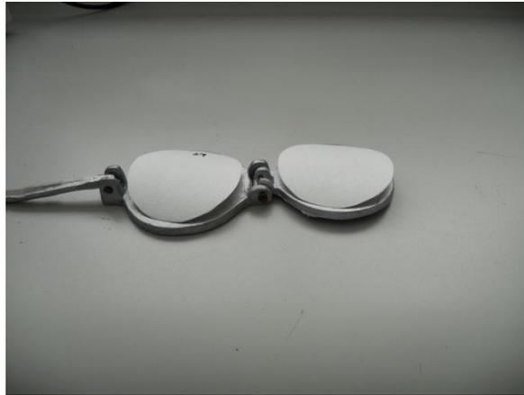
Figura 16: Compresor mecánico con los trozos de papel filtro para la obtención del porcentaje de agua drenada deformación.
