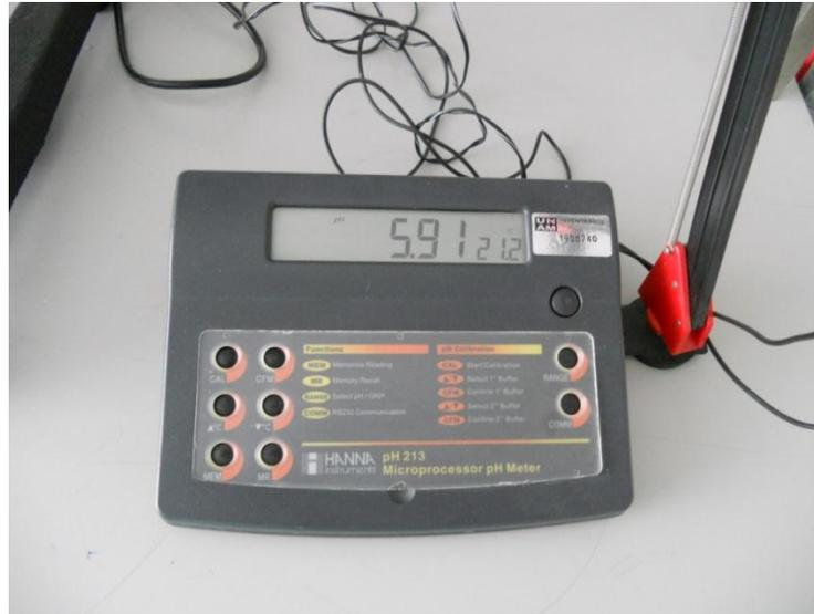
Figura 12: Potenciómetro HANNA 213 utilizado en la obtención del pH de las diferentes muestras.
