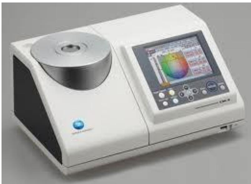
Figura 15: Colorímetro Konica minolta CM5 utilizado en la obtención de los parámetros L\*, a\* y b\* de los drenados del marinado.
