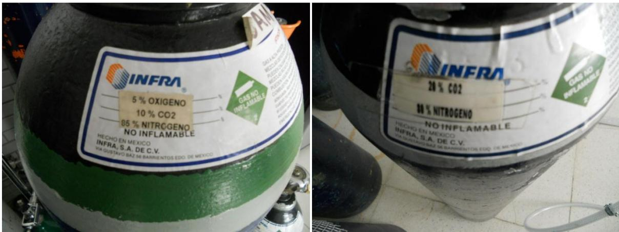
Figura 11: Tanques con las diferentes mezclas de gases utilizados para la creación de las atmosferas modificadas activas. a) Mezcla 1: 5%  $O_2$  / 10%  $CO_2$  Y 85%  $N_2$ . b) Mezcla 2: 20%  $CO_2$  Y 80%  $N_2$ .
