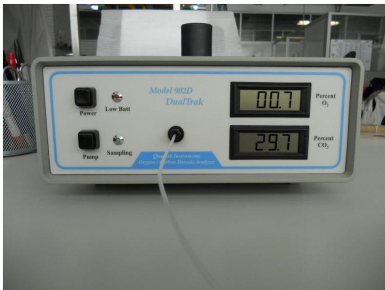
Figura 18: Analizador de Oxígeno-Dióxido de carbono utilizado para la obtención de la concentración de gases dentro del envase.
