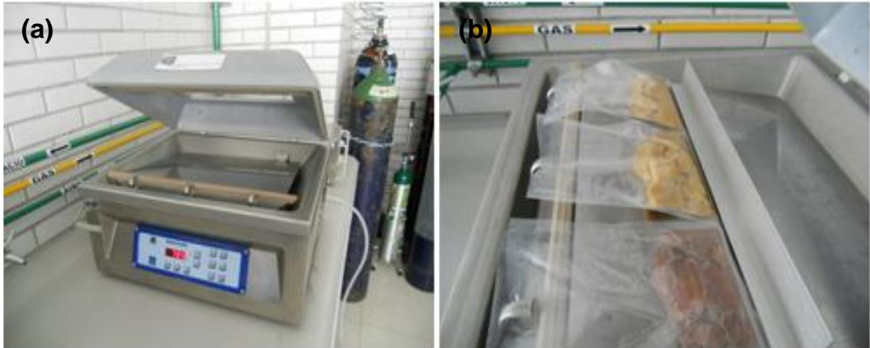
Figura 10: (a). Envasadora automática tipo campana MULTIVAC A 300/16. (b). Muestras de pechuga marinada previas a la inyección de gases.
