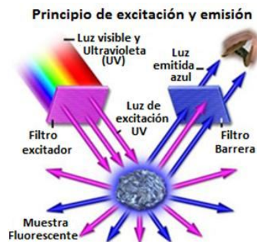
Figura 3.3. Ejemplificación del efecto de excitación y emisión de una partícula luminiscente.
