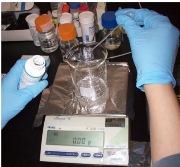
Figura 2.8. Fotografía del proceso de preparación de la relación 10:1 del pre-polímero y el agente curante.
