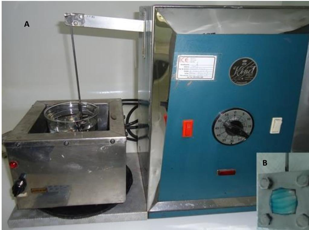
Figura 21. A) Representación del método 1, modificado del desarrollado por Nakamura & Ohta (1996) y reportado por Bacchav & Patravale (2009), utilizando como medio solución amortiguadora de fosfatos. B) Placa de acero inoxidable con el tejido vaginal y el gel de CAP.
