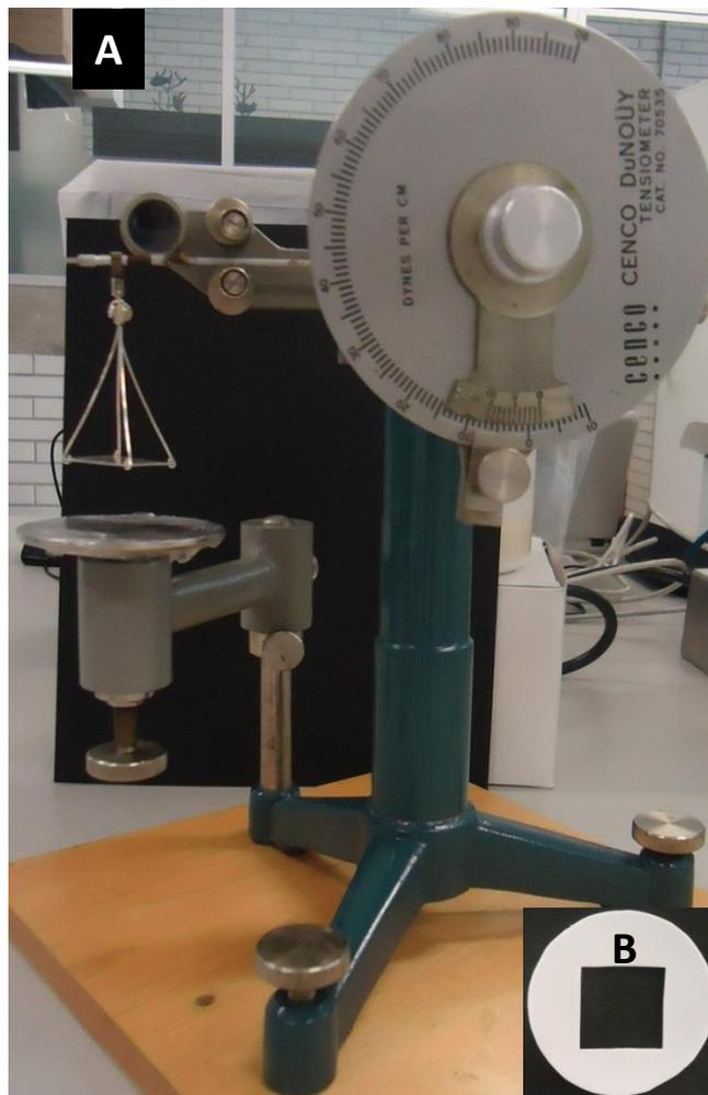
Figura 17. A) Tensiómetro de Du Noüy modificado. B) Placa de teflón adaptada para sujetar el tejido vaginal de cerda en la plataforma del tensiómetro.
