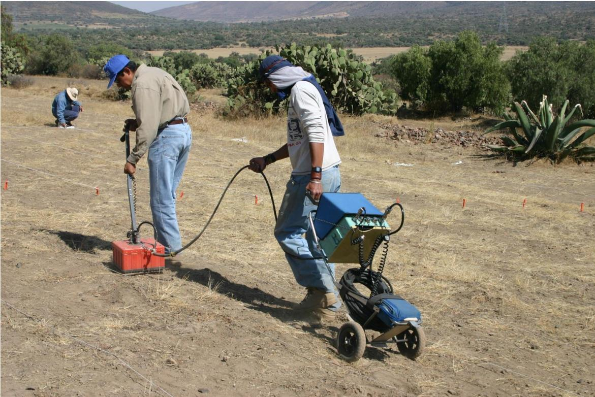
Figura 10. Recorrido del área con el radar de penetración terrestre (gpr).
