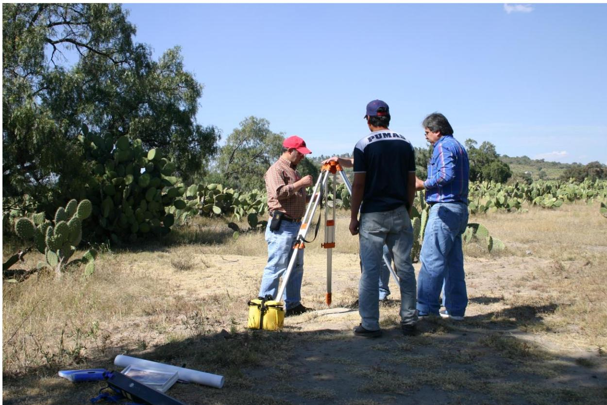
Figura 6. Colocación de la unidad del GPS base en el punto Geodésico de INEGI.
