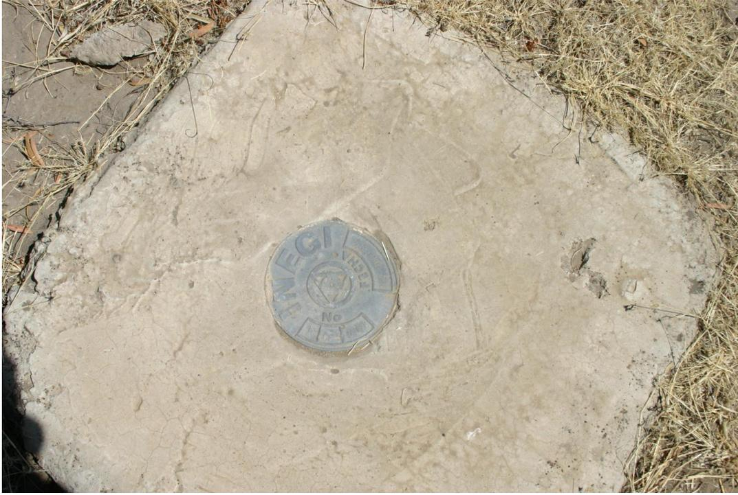
Figura 5. Placa del punto Geodésico de INEGI.
