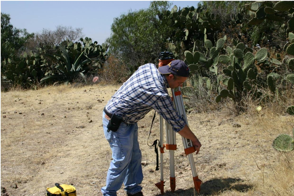
Figura 7. Colocación de la estación móvil al banco de nivel o punto A del polígono del área de excavación.
