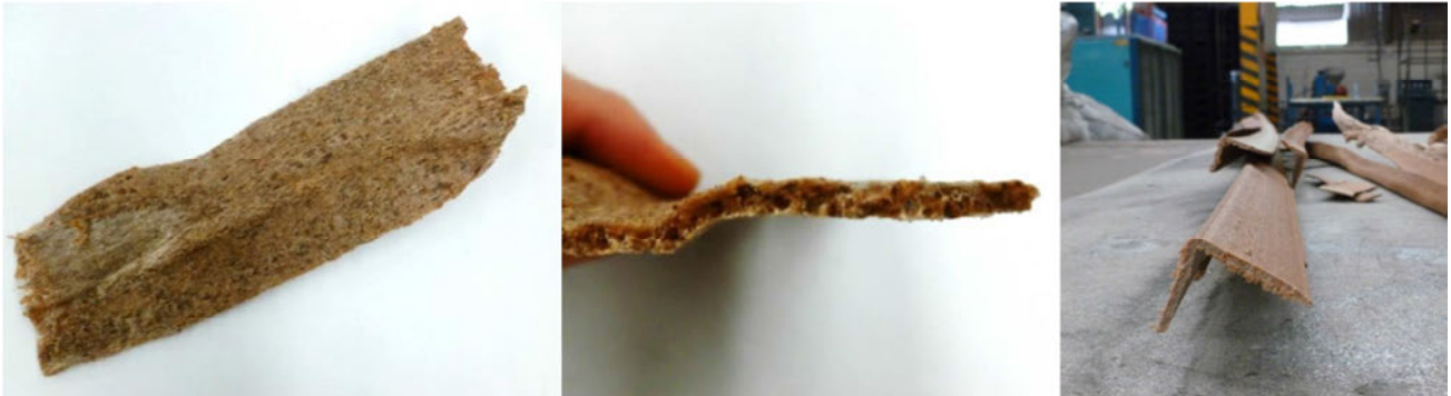
Figura 64. Muestras de perfil extruido composición 80/20 PLA/FAT.
