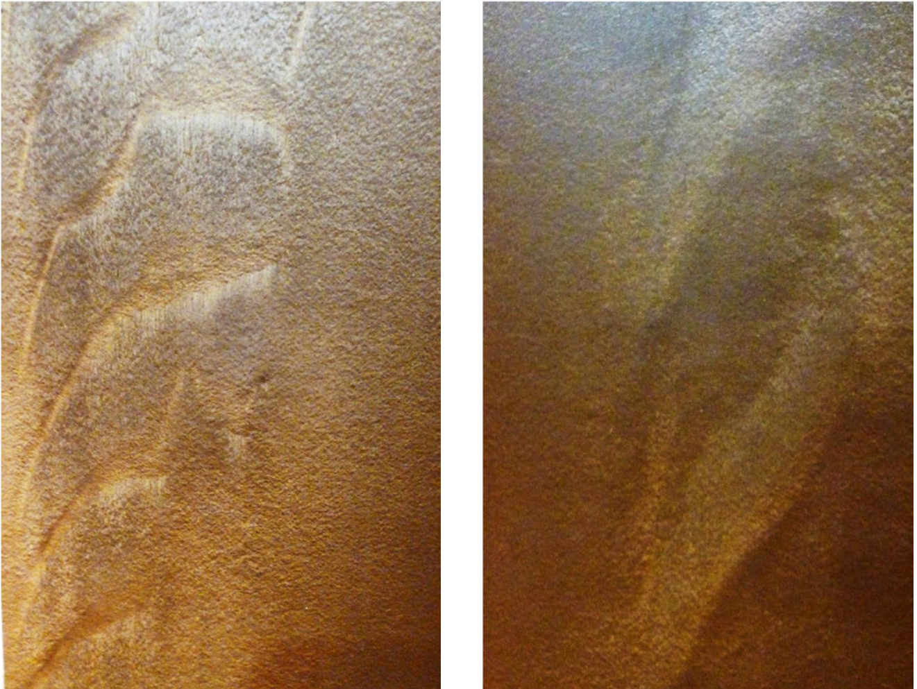
Figura 68. Sección de láminas de biocompuesto PLA/FAT con vetas de extrusión.
