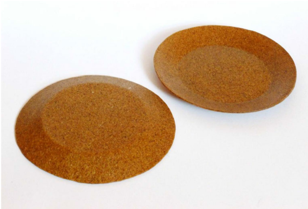
Figura 56. Platos obtenidos mediante moldeo por compresión.
