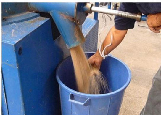
Figura 63. Extrusión del biocompuesto PLA/FAT.
