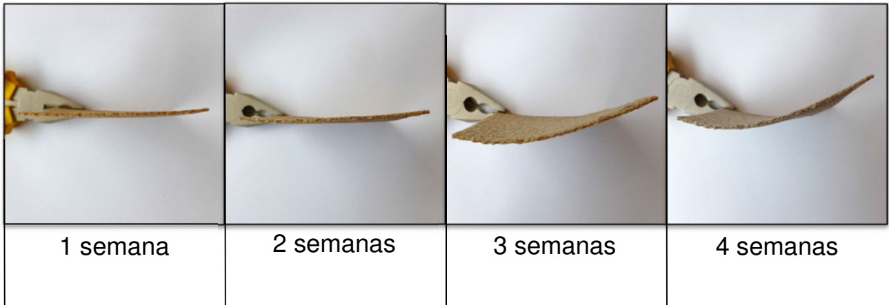
Figura 48. Deformación del biocompuesto con un contenido de fibra del 40%.
