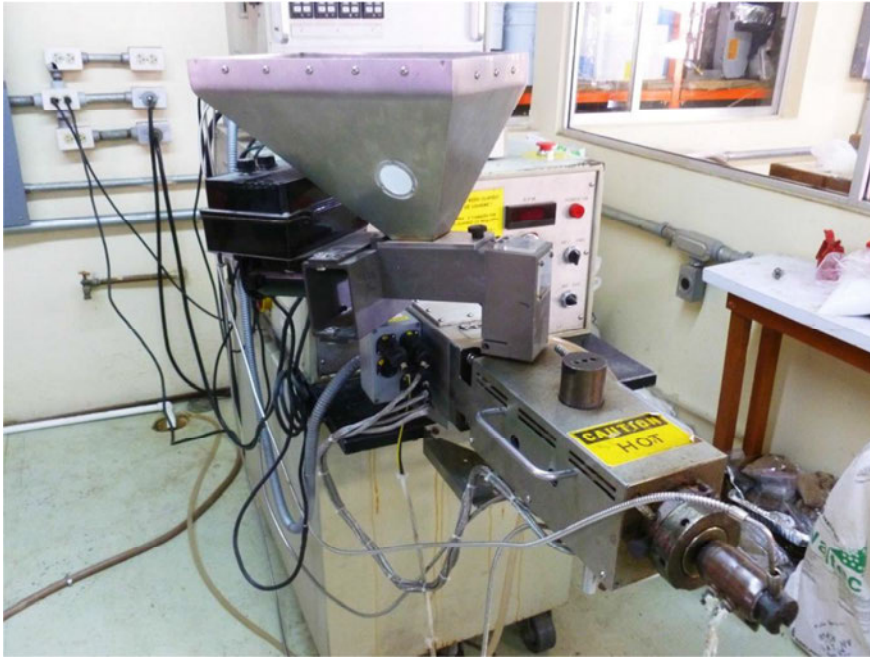
Figura 27. Extrusor doble husillo utilizado para obtener la muestras para el análisis.
