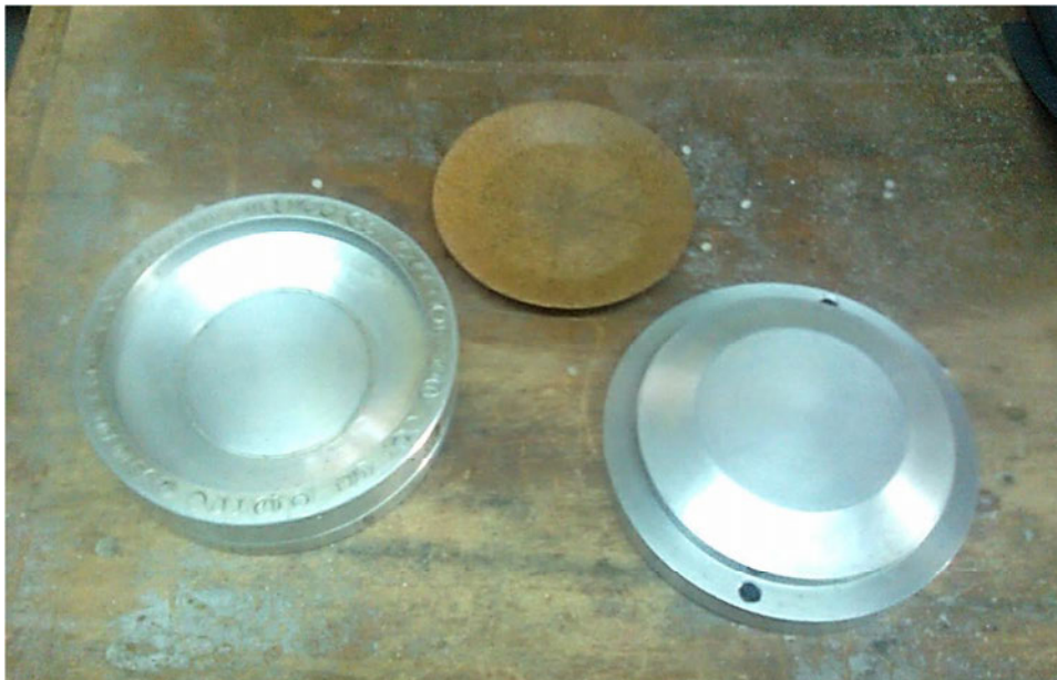
Figura 55. Molde de aluminio para pruebas de moldeo por compresión.
