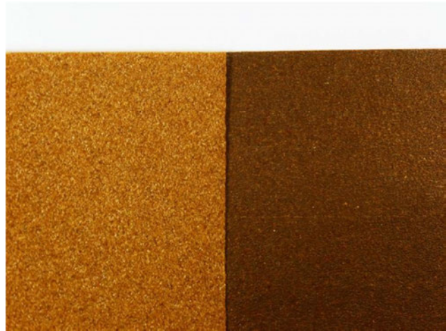
Figura 66. Comparación de color entre láminas del biocompuesto PLA/FAT.
