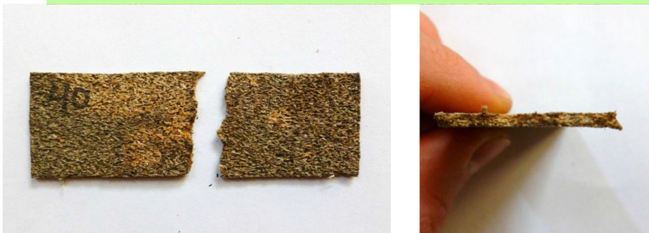
Figura 53. Muestra con un contenido del 40% de fibra después de dos meses de entierro.
