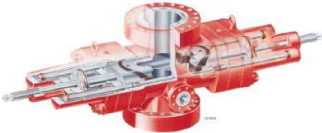
Figura AN. Preventor de arietes anulares.
