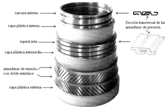
Figura CC. Configuración interna de riser flexible
