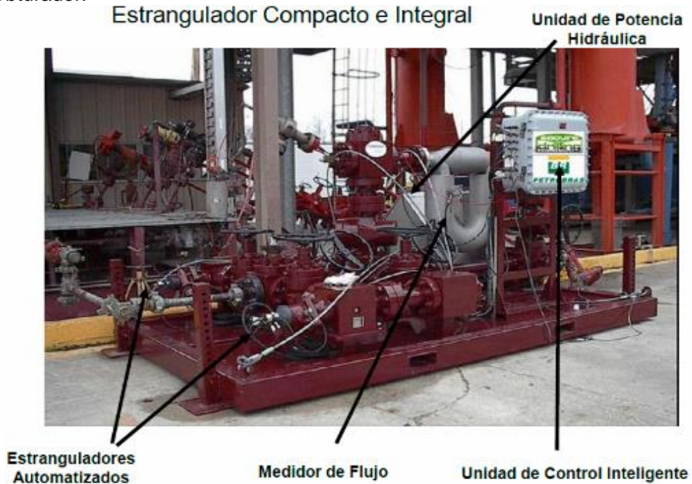
Figura BI. Choke manifold (Múltiple de estrangulación)
