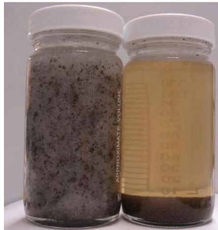
Fig.4.3. -Surfactante en suspensión después de un tiempo con una temperatura de 800F, la muestra de la izquierda es un fluido con nanopartícula y el otro es sin nanopartículas. 4.3
