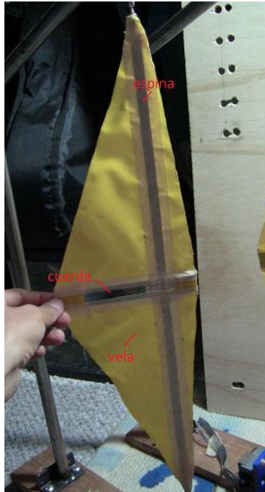
Fig. 4.2.1 Esquema del Ala del dispositivo Aeroflexor.
