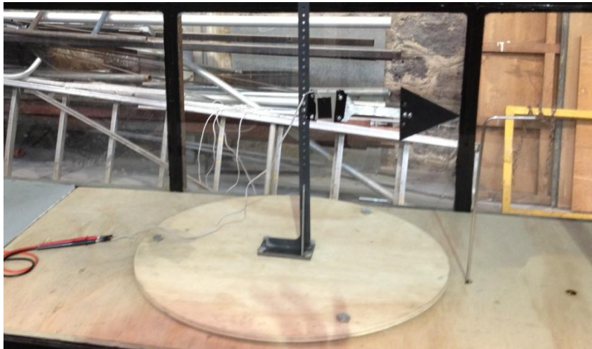
Fig. 5.2.2.1 Arreglo Piezo-Leaf en la estructura metálica para las pruebas en el túnel de viento.
