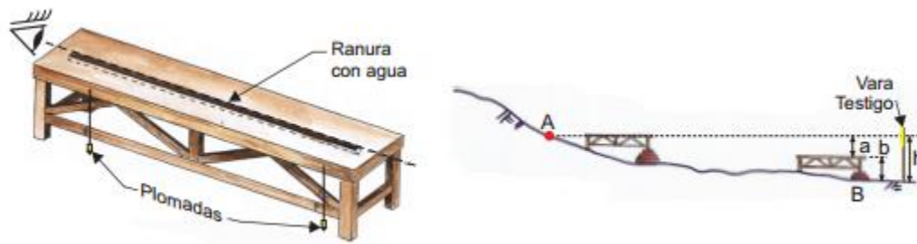
Figura 1. 1. Uso del corobate como instrumento topográfico (Santoyo y Ovando, sitio web TGC)
