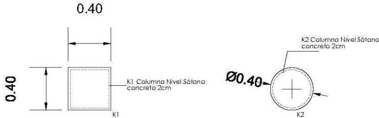
02 DET/Columna de concreto K1-K2 [Dimensiones] Esc. 1:40
