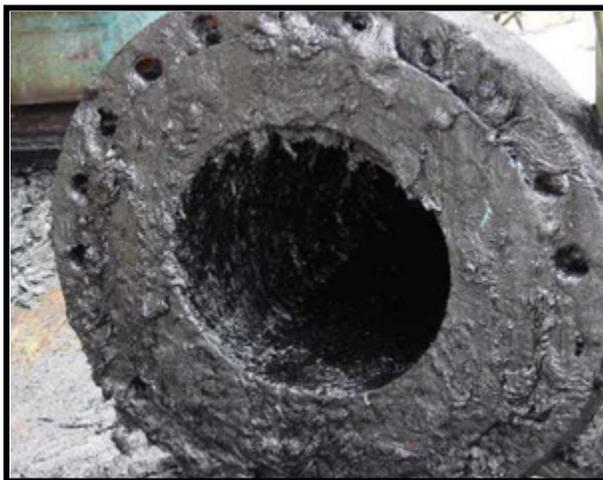
**Imagen 2.7. Depósitos de asfáltenos en tuberías.**
