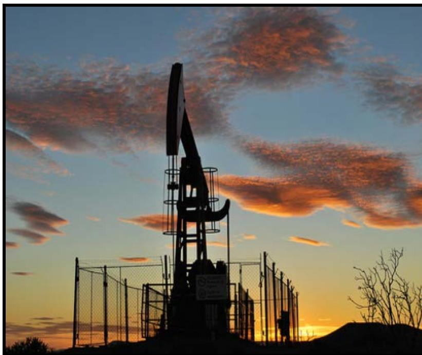
**Imagen 6.27. Estructura superficial de una unidad de bombeo mecánico convencional.**
