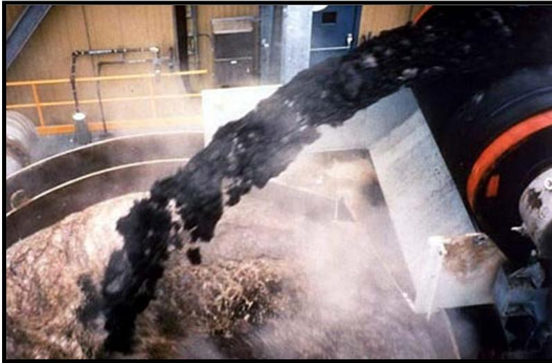
**Imagen 5.2. Procesamiento de bitúmenes en naves de separación primaria.**
