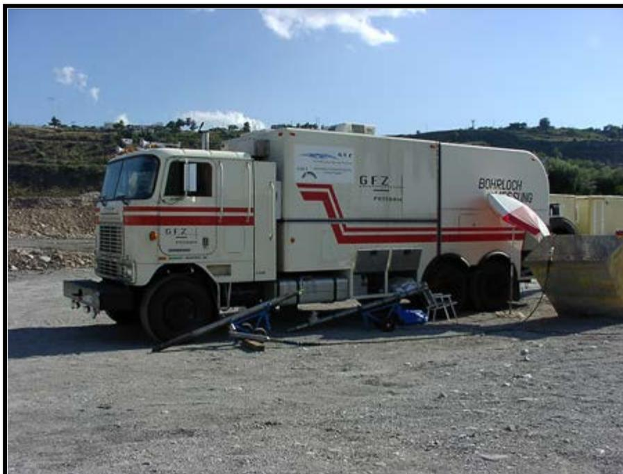
**Imagen 3.5.** Equipo generalmente empleado para la toma de registros geofísicos.
