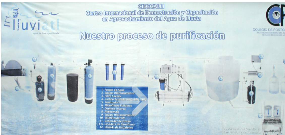
Figura 26. Proceso de purificación del CIDECALLI – 1. Fuente de agua, 2. Equipo hidroneumático, 3. Filtro speedy, 4. Carbón activado, 5. Suavizador o salmuera, 6. Microfiltros pulidores, 7. Osmosis inversa, 8. Almacenamiento, 9. Equipo hidroneumático, 10. Esterilizador UV, 11. Generador de ozono, 12. Lavadores de garrafontes, 13. Llenador de garrafontes.
