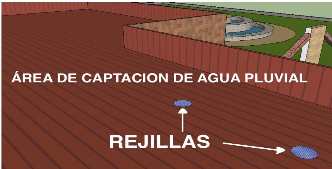
Figura 36. Rejillas en el área de captación de la Biblioteca Mtro. Enrique Rivero Borrell
