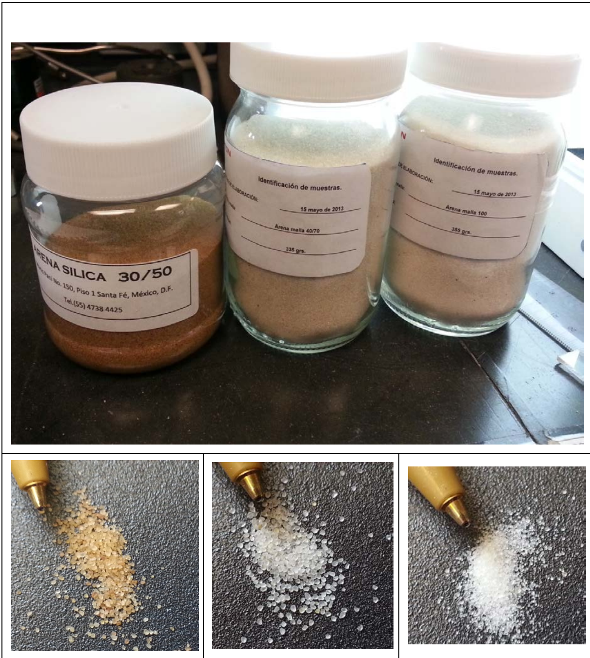
Figura 42.- Arenas silica malla 30/50, 40/70 y 100 respectivamente
