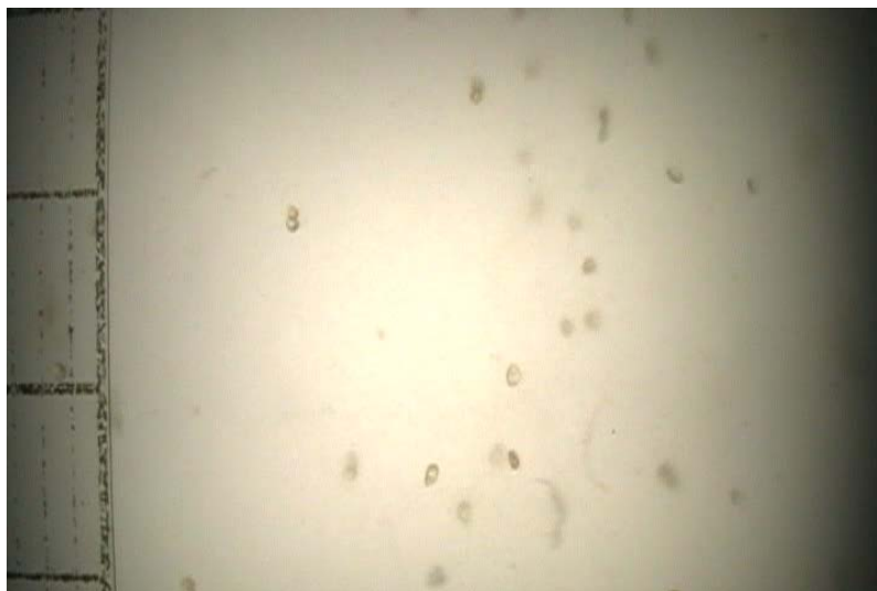
Figura 46.- Imagen del apuntalante arena silica malla 30/50 en fluido lineal.
