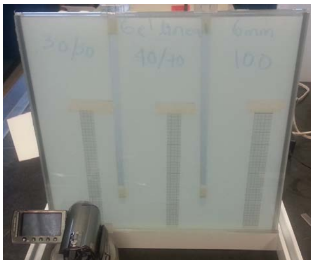
Figura 44.- Maqueta experimental con papel milimétrico para observar y medir el desplazamiento de apuntalantes.
