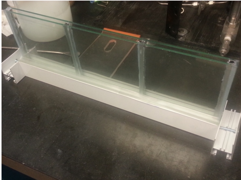
Figura 45.- Maqueta utilizada para el experimento de asentamiento de apuntalante en gel reticulado.
