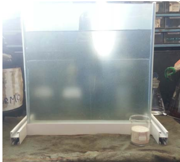
Figura 43.- Maqueta experimental para asentamiento de apuntalantes con fluido línea.
