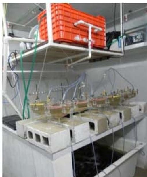
**Figura 21. - Sistema de respirometría para BFT**
