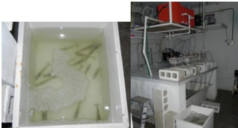
**Figura 9. (a)Organismos en tara de aclimatación en el cuarto húmedo para continuar con la respirometria. (b) Sistema de respirometria con recirculacion de agua clara**
