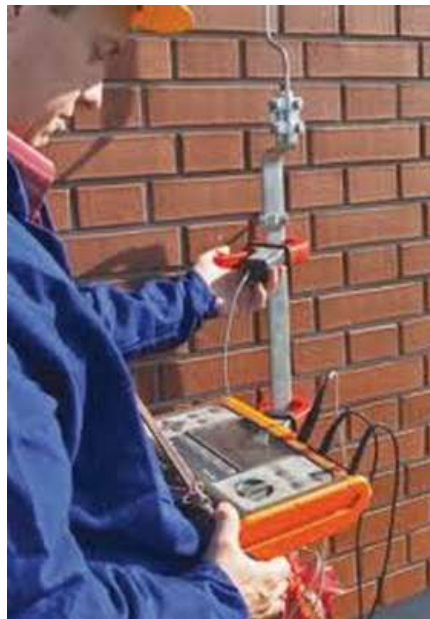
Figura 4.3 Medición de puesta a tierra con teluometro.
