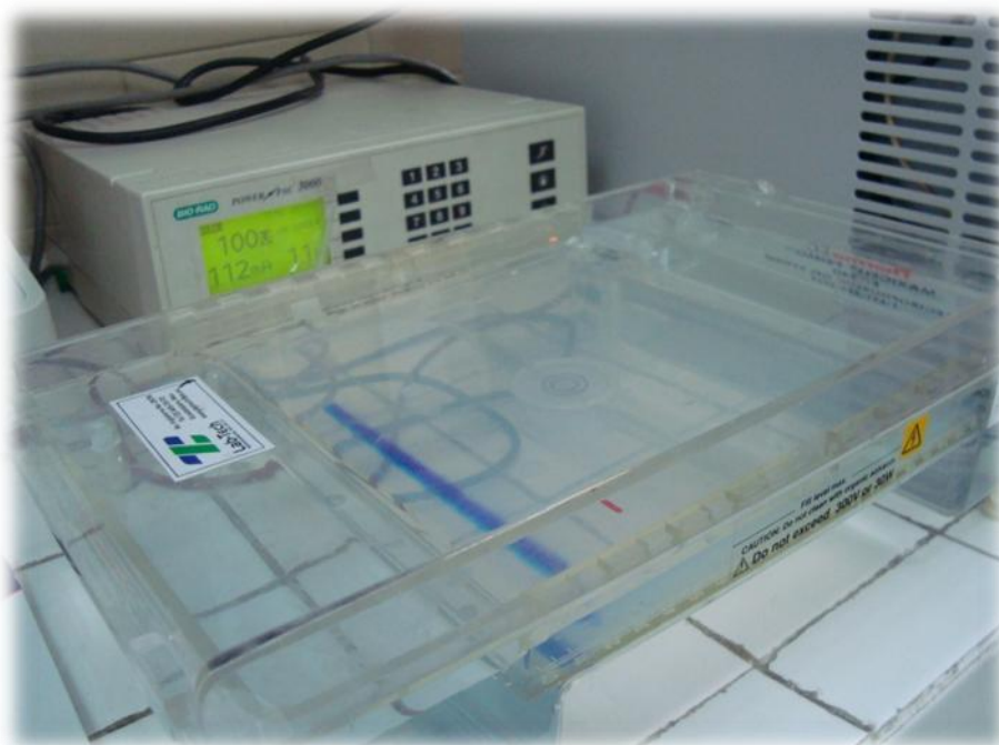
FIGURA 9. Separación de los productos por electroforesis en gel de agarosa al 2%/TBE 1X
