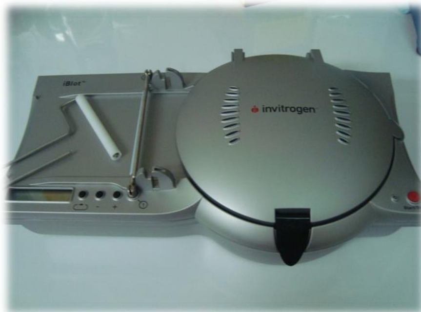
FIGURA 10. Equipo iBlot® de Invitrogen, para realizar la transferencia de DNA o proteínas, en seco aplicando voltaje.
