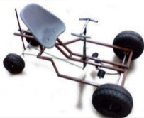
Primer simulador fabricado para pruebas de distribución y función.
