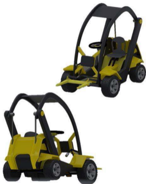
Versión final 2011. Propuesta con chasis metálico y piezas en inyección.
