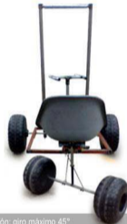
Prueba de dirección: giro máximo 45°
