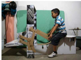
Prueba de relación distancia - ganancia mecánica. Posición final.
