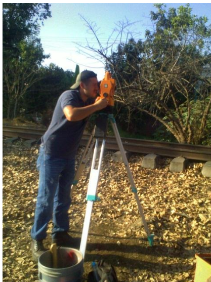
Imagen. 6.1. Levantamiento con estación total. (Fuente: Propia)
