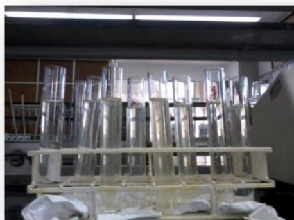
Figura 5.2. Método de colorimetría para nitrógeno amoniacal
