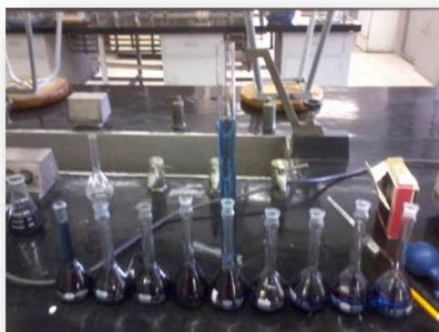
Figura 5.8. Método de colorimetría para Fósforo
