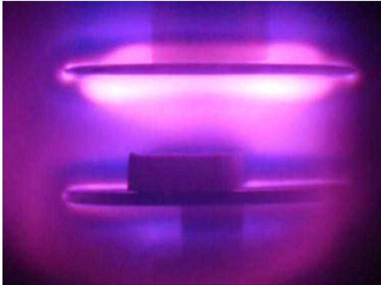
Figura 7. Fotografía del interior de la cámara durante la degradación con plasma de aire.
