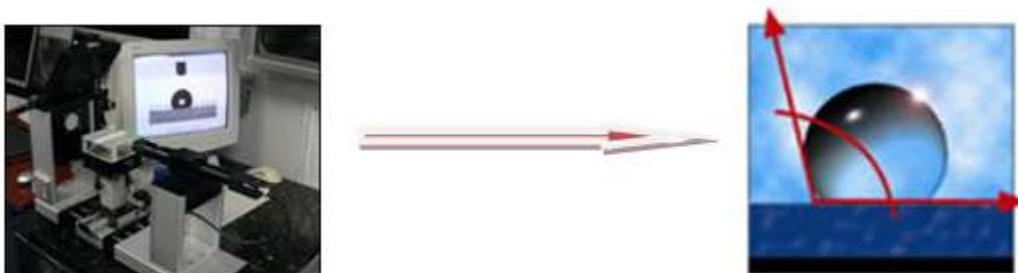
Figura 11. Equipo y esquema de cómo se realiza la medición del ángulo de contacto.
