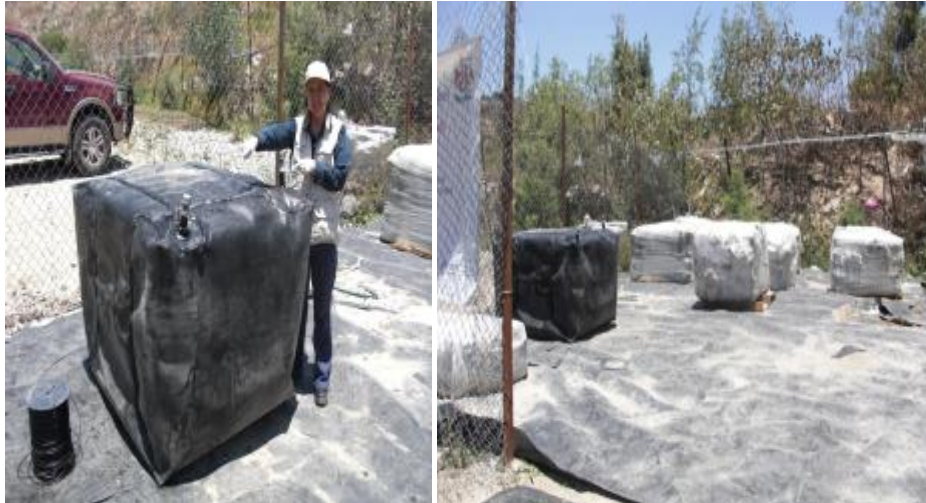
Fig. 3.3. Pacas de LDPE y paca encapsulada con HDPE.
