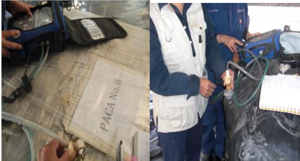
Fig. 4.17. Medición del biogás en las pacas con LDPE y en la cápsula de HDPE.
