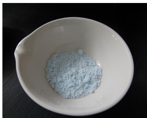
Figura 4.8. Catalizador impregnado con solución de níquel y EDTA.
