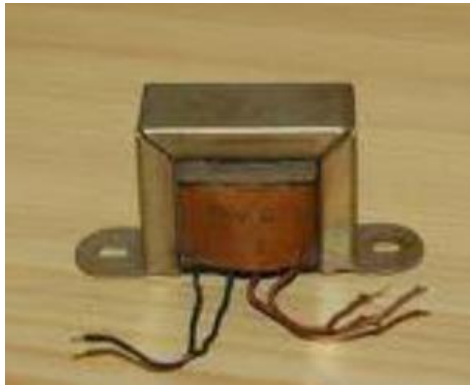
Figura 2-3. Transformadores de entrada.
