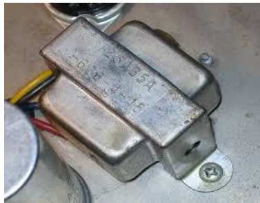
Figura 2-4. Transformadores de salida.
