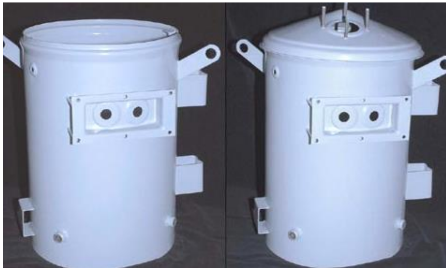
Figura 4-6. Repintado y cambio de empaquetaduras en tanque de transformador eléctrico.
