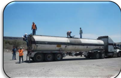
En la Planta de Asfalto. Se toman Muestras del Cemento Asfáltico.
