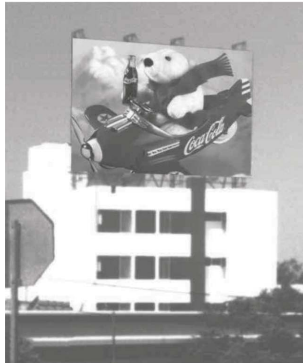
▲ Espectacular de Coca-cola, su dimensión; de alto: 8.0mts, de ancho: 12.0 mts. Su altura de 15.0mts. Su iluminación es de aditivos metálicos (luz blanca) 800 watts.
