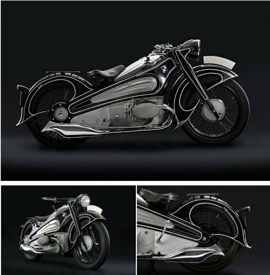
Fig. 10 Motocicleta R 7 de BMW cuyo prototipo fue fabricado en 1934 pero nunca se llevó a producción. El diseño fue desarrollado por el ingeniero Alfred Böning con clara influencia del Art Deco en el uso de líneas limpias, cromo y acero. En 2005 se retomó y se reconstruyó el prototipo de acuerdo a los planos originales, la pieza se considera una obra maestra de la ingeniería y el diseño de los años 30.
