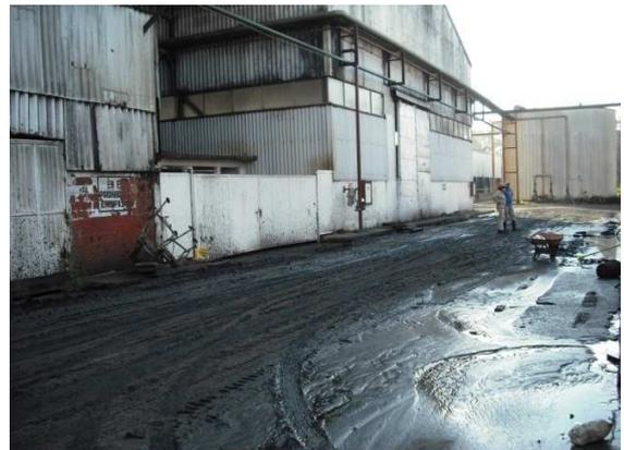
Fotografía A5.24 Derrame de decantador de lodos de ceniza
