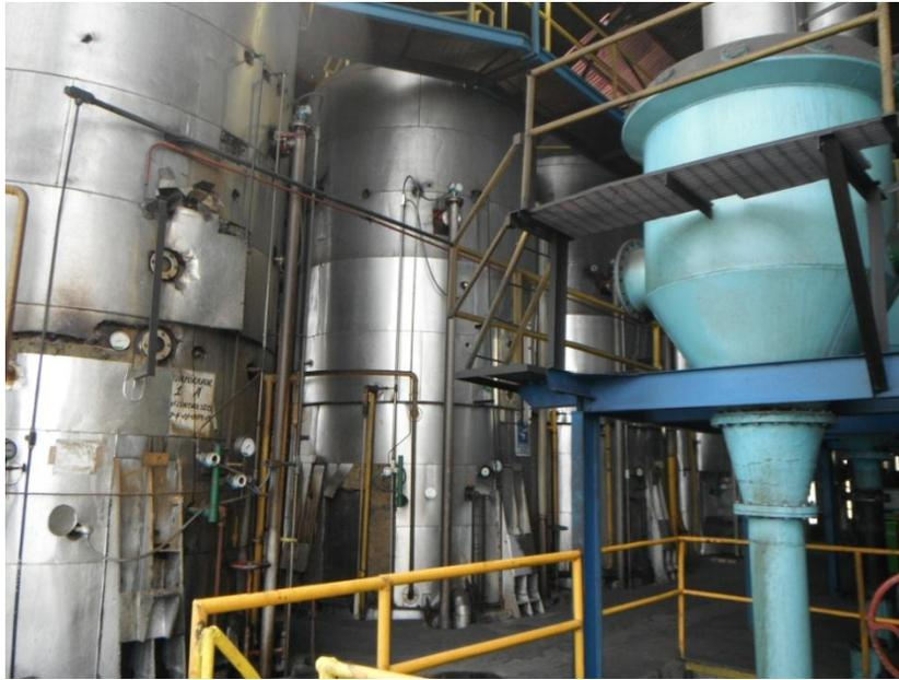
Figura 4.35 Evapores de cuádruple efecto y condensadores barométricos.
