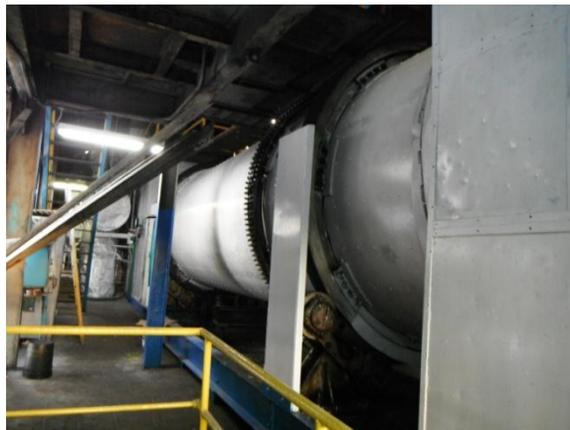
Figura 4.40 Secadores rotativos de azúcar húmeda.
