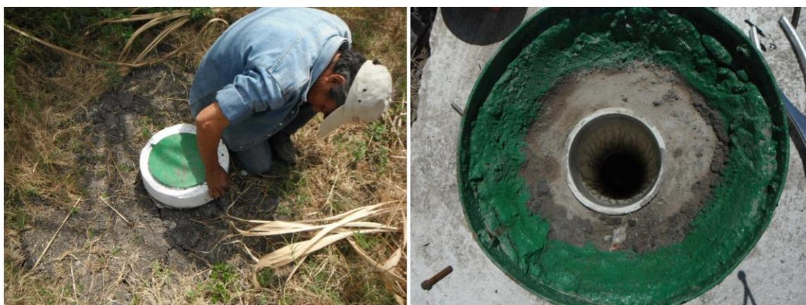
Figura 4.46 Pozos de monitoreo de calidad de agua a nivel freático, de la zona cañera que se abastece con agua residual del FIEZ.
