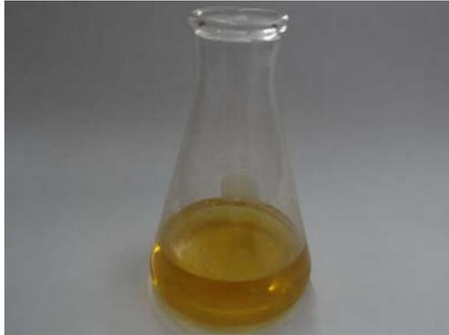
Fotografía 3. Ácidos grasos hidrogenados con índice de yodo cercano a 30 mgI/g. Se observan, como manchas oscuras, restos de catalizador que se asentaron durante el enfriamiento de los ácidos.
