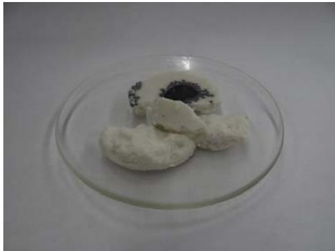
Figura 4. La N, N'-etilenbis(estearamida) recién retirada del reactor en forma de escamas. El color amarillento se presenta únicamente en las superficies del sólido que estuvieron expuestas al aire durante el enfriamiento. La masa interna de las escamas de oleamida es blanca.
