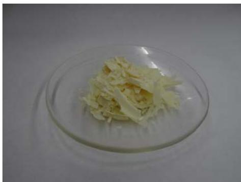
Figura 5. La N, N'-etilenbis(estearamida) molida hasta malla 200 utilizando un molino de bolas. El polvo es impalpable, color casi blanco, un tono gris muy leve fue adquirido por las amidas durante la molienda.
