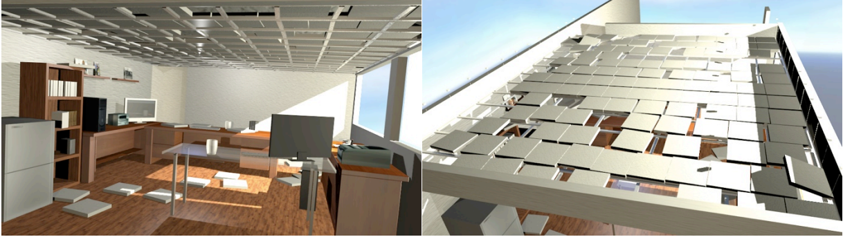
Figura 25. Terremoto en la oficina, caso 2. Vista del interior y de los plafones.
