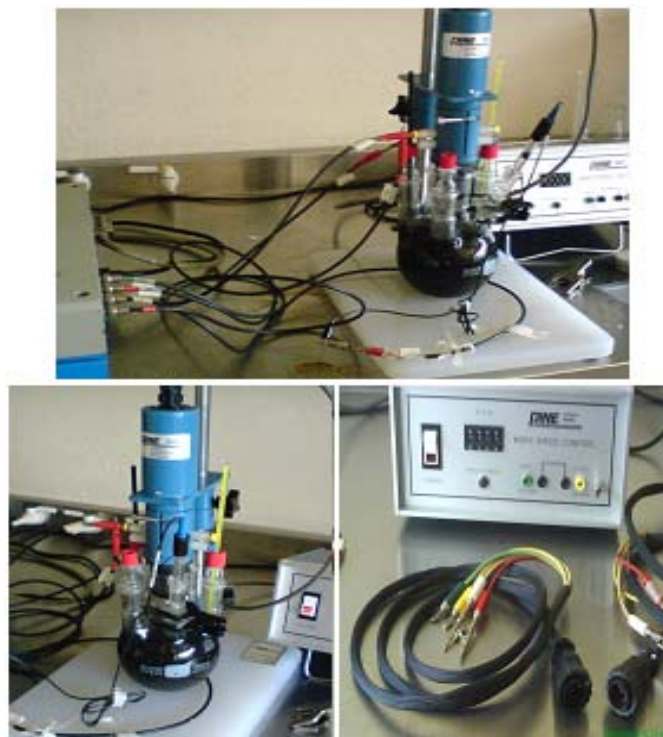
Figura 2.3.1 Sistema empleado para medir la potencia a circuito abierto, resistencia a la polarización e impedancia electroquímica.
