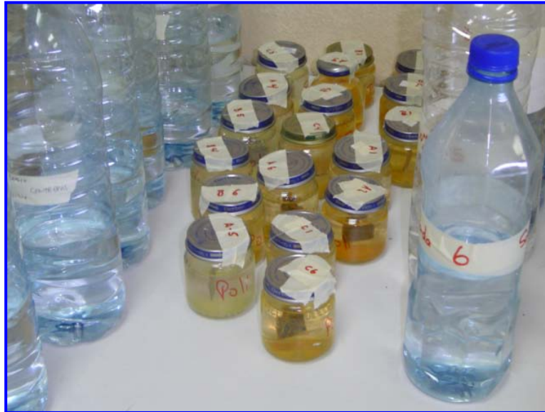
Figura 2.2.1 Sistemas empleados para la ejecución de la prueba gravimétrica.
