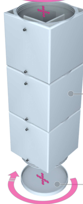
Imagen 46.- Funcionamiento del módulo multifuncional para el almacenamiento de agua. Elaboración propia. Derechos reservados.
