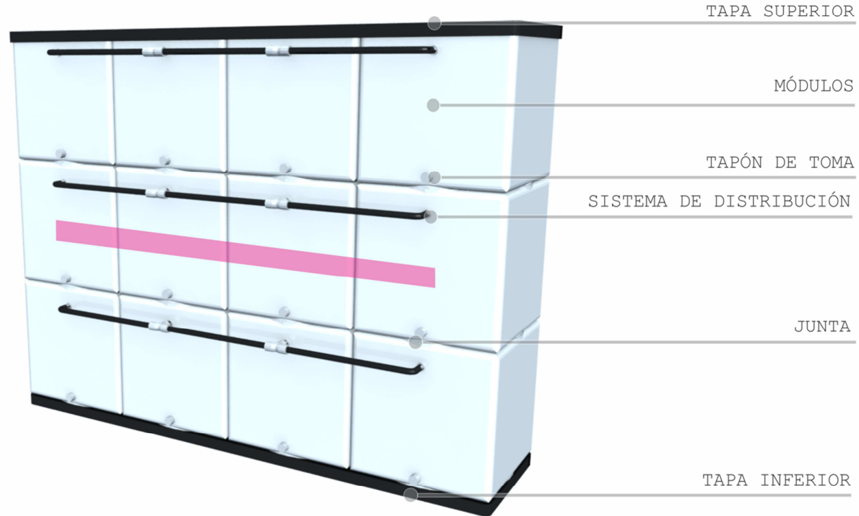
Imagen 50.- Apariencia final del módulo multifuncional para el almacenamiento de agua. Elaboración propia. Derechos reservados.
