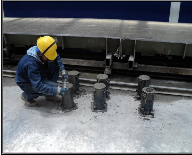
Figura N° 20. Verificación de laboratorio toma de muestras de cilindros de 15 x 30 cm.
