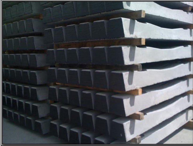
Figura N° 22. Almacenamiento de durmientes monobloque pretensado.
