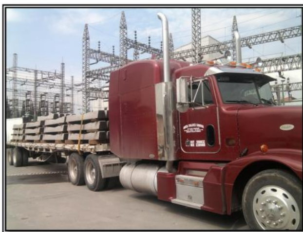
Figura N° 24. Transporte de durmientes monobloque pretensado en tráiler de 4 ejes para línea 12 del metro de la ciudad de México.
