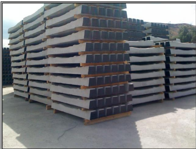
Figura N° 23. Estibado de durmientes monobloque pretensado en 12 camas.
