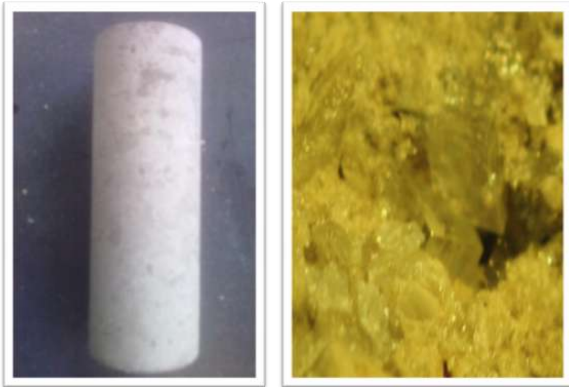
Figs. 5-3 y 5-4 Núcleo de caliza y cristales de Calcita.
