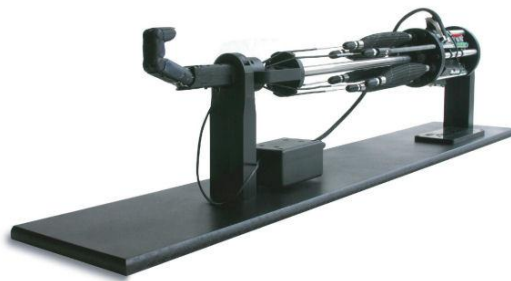
Figura 1.15. Dedo para pruebas desarrollado por “ Shadow Robot Company ” nótese que los actuadores (neumáticos) se encuentran fuera de las falanges del dedo y que utiliza tendones para transmitir la fuerza.
