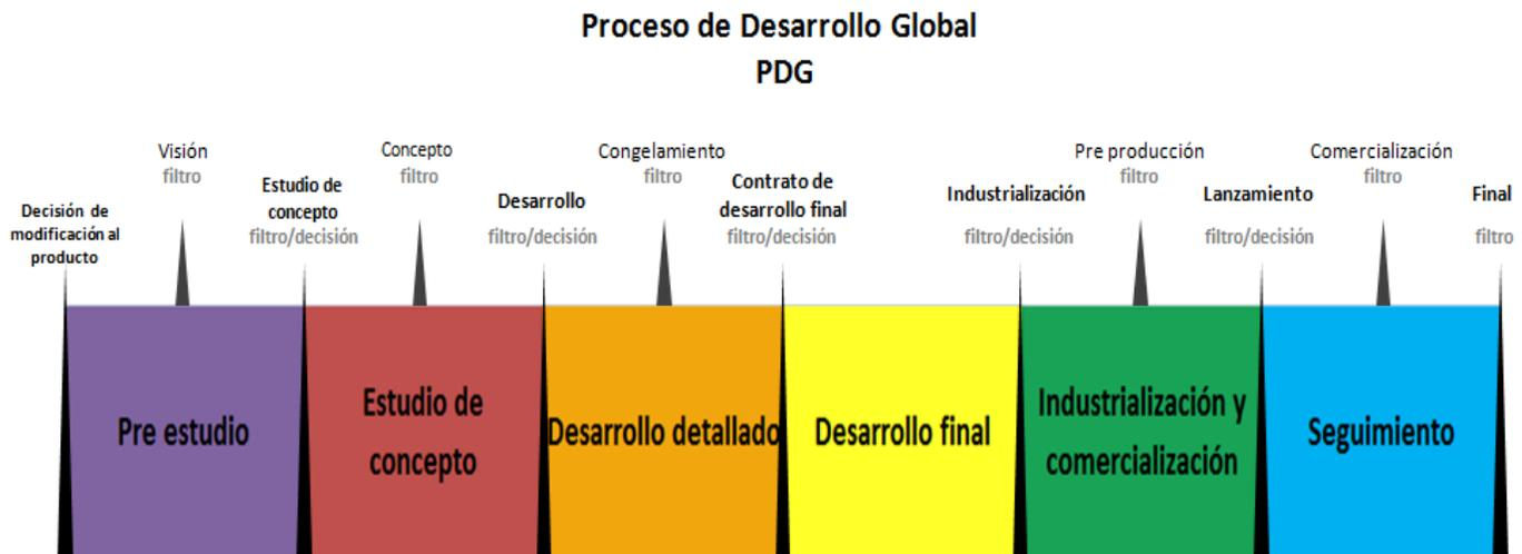
Figura 5 [Elaboración propia]. Esquema de las fases que conforman el PDG en la empresa productora de autobuses. En él se muestra la secuencia de filtros realizados al proyecto y los puntos de decisión ejecutados durante el proceso de desarrollo.
