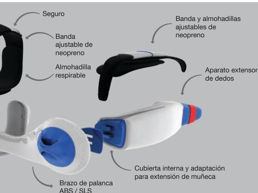
Fig.11. 8. Despiece módulo de muñeca
