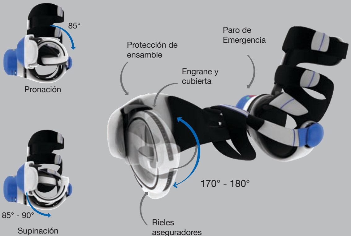
Fig.11. 11. Módulo de codo. A la izquierda pronación y supinación, a la derecha, rangos de movimiento
