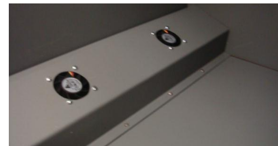
Figura 4.29 Base Ventiladores. Inclinación de 30°
