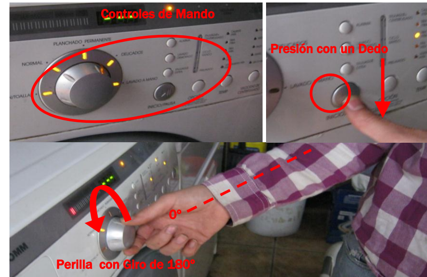
Figura 4.61 Proceso de Programación y Control de la Lavadora.
