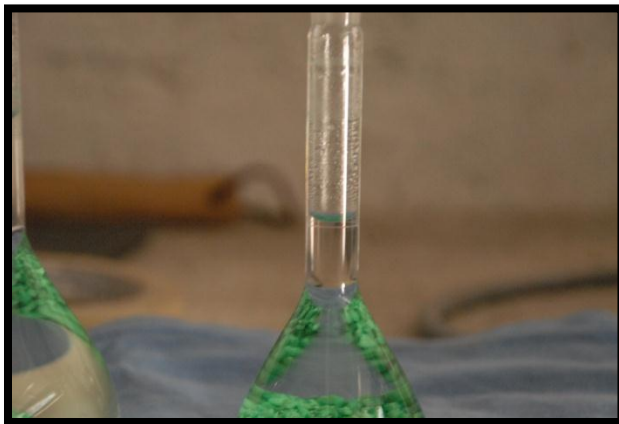
Figura 3.7 Material sometido a “Baño María”. En las imágenes central e izquierda superiores, después del baño maría. En las mismas imágenes, además de las dos fotos inferiores, se ilustra la dilatación del agua destilada al estar el nivel del agua por encima de la marca de enrase
