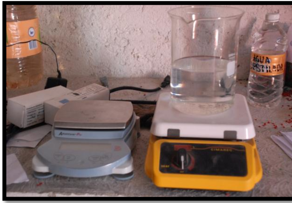
Figura 3.6 Báscula electrónica (izquierda) y calentador eléctrico junto con vaso de precipitado (derecha)
