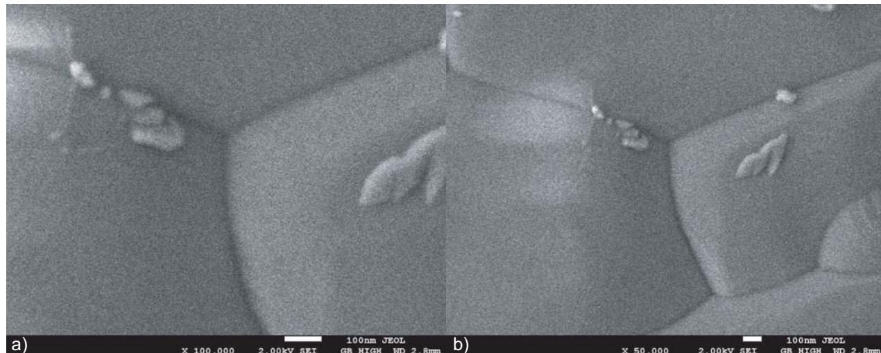
Figura 4.27: Micrografías de barrido de la muestra HA3C, con temperaturas de mezclado a 44 °C y de calcinación a 1200 °C, a) a x100k y b) a x50k.
