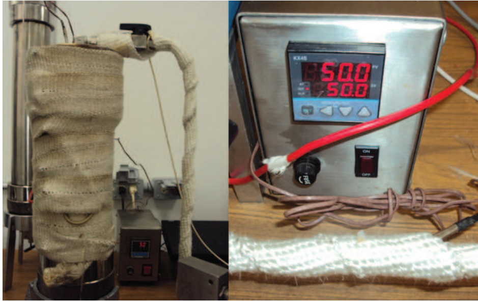
Fig. F.1 Controladores de la temperatura.
