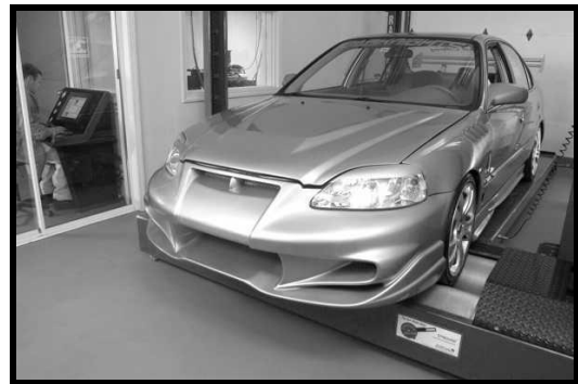
Fig. II.16. Prueba sobre Dinamómetros de chasis a) Con camioneta convencional b) vehículo ligero.
