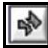
Fig.V.14. La flecha rota de ejecución provee de información inmediata de errores sintácticos en el código G.
