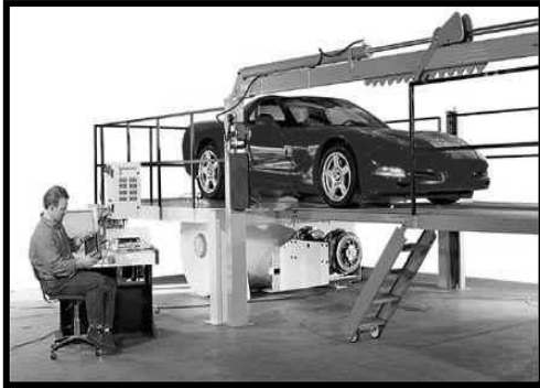
Fig. II.18. Dinamómetro de chasis, para desarrollo de vehículos.
