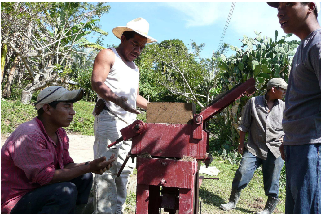
3. El día en que se inicio la producción de los bloques de tierra compactada (B.T.C.).
