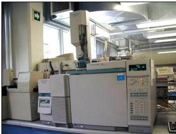
Figura 0.8 Cromatógrafo de gases acoplado a un detector selectivo de masas
