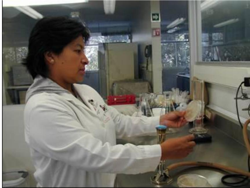
**Figura 0.18** Verificación del grado de esterilidad de los suelos mediante técnicas de conteo en placa
