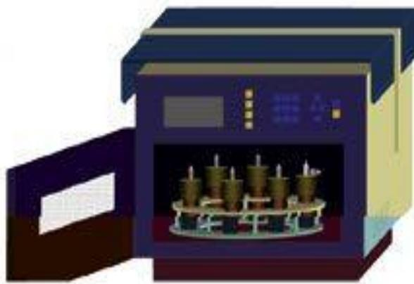
**Figura 0.6** Equipo de extracción de compuestos orgánicos por microondas
