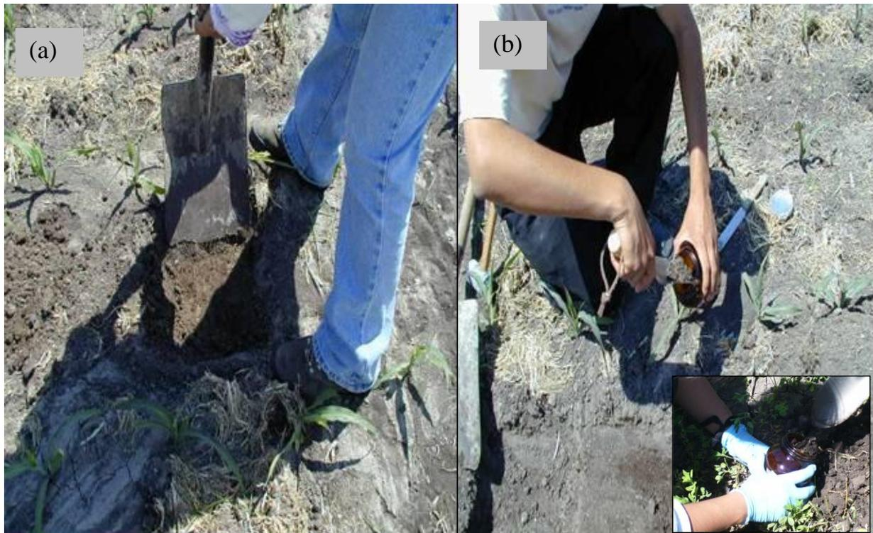
**Figura 0.15 Muestreo de suelos alterados en Atitalaquia (a) limpieza del sitio de muestreo, se retiran hierbas y basura superficial; (b) toma de muestra hasta la profundidad del horizonte Ap, el cual varía en cada perfil**
