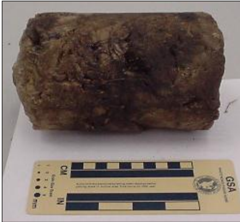
Figura 6.- Pozo A-1 Núcleo-1 Brecha calcárea parcialmente dolomitizada con presencia de vóculos asociados a fracturas con impregnación de aceite pesado
