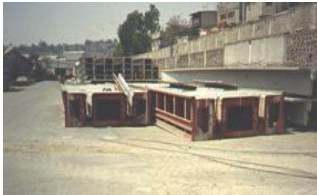
Molde autotensable de acero (trabe doble T)
