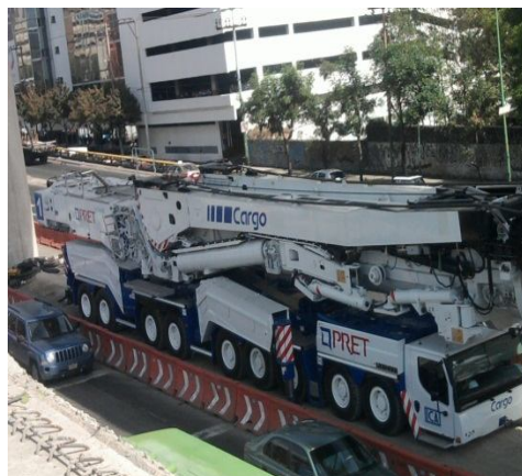
GRÚA TELESCÓPICA PARA MONTAJE DE COLUMNAS Y TRABES PREFABRICADAS
