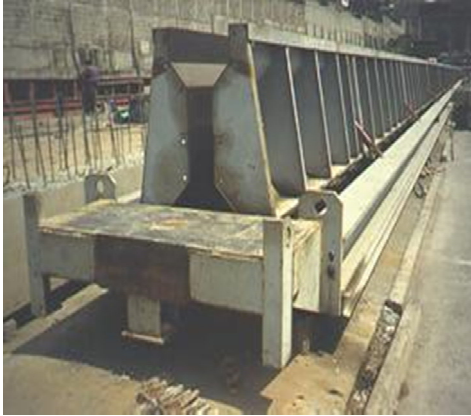
Molde metálico autotensable de sección I
