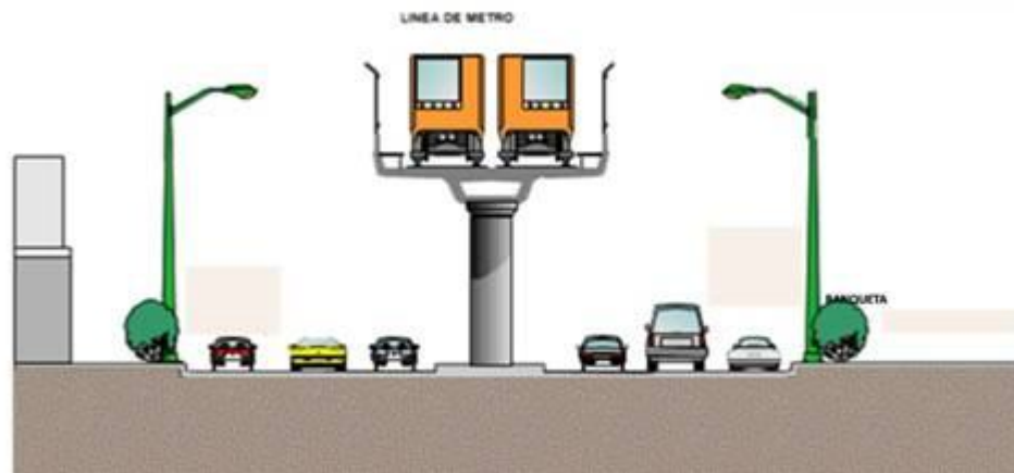
Sección terminada del viaducto elevado
