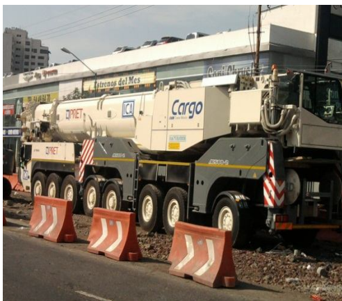
GRÚA TELESCÓPICA PARA MONTAJE DE COLUMNAS Y TRABES PREFABRICADAS
