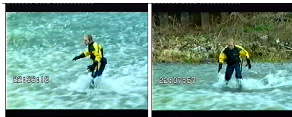
Ilustración 5.5 Experimento de inestabilidad durante un flujo de inundación.
